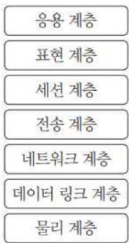
'계층 1'인 물리 계층은 네트워크 케이블을 통해 송수신되는 물리적 신호의 전송 규칙을 조정하고 신호를 송수신하는 역할을 한다. 일반적으로 네트워크 케이블을 통해 정보를 송수신할 경우에는 디지털 데이터를 전기적 신호로 변환하는 장비인 DSU(Digital Service Unit)를 거쳐야 한다. 이때 디지털 데이터를 전기적 신호로 변환하는 부호화 과정을 라인 코딩이라 한다. 라인 코딩의 방식에는 여러 종류가 있는데, NRZ(Non Return to Zero) 방식에서는 비트
