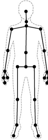
동작 추적 센서의 하나인 키넥트 센서는 적외선 카메라와 RGB 카메라 등으로 구성된다. 적외선 카메라는 광원에서 발산된 적외선이 피사체의 표면에서 반사되어 수신되기까지 걸리는 시간을 측정하여, 피사체의 입체 정보를 포함하는 저해상도 단색 이미지를 제공한다. 반면 RGB 카메라는 피사체의 고해상도 컬러 이미지를 제공한다. 키넥트 센서는 저해상도 입체 이미지를 고해상도 컬러 이미지에 투영하여 사용자가 검출되는 경우, <그림>과 같이 신체 부위에 대응되는 25개의 연결점을 선으로 이은 3D 골격 이미지를 제공한다.
